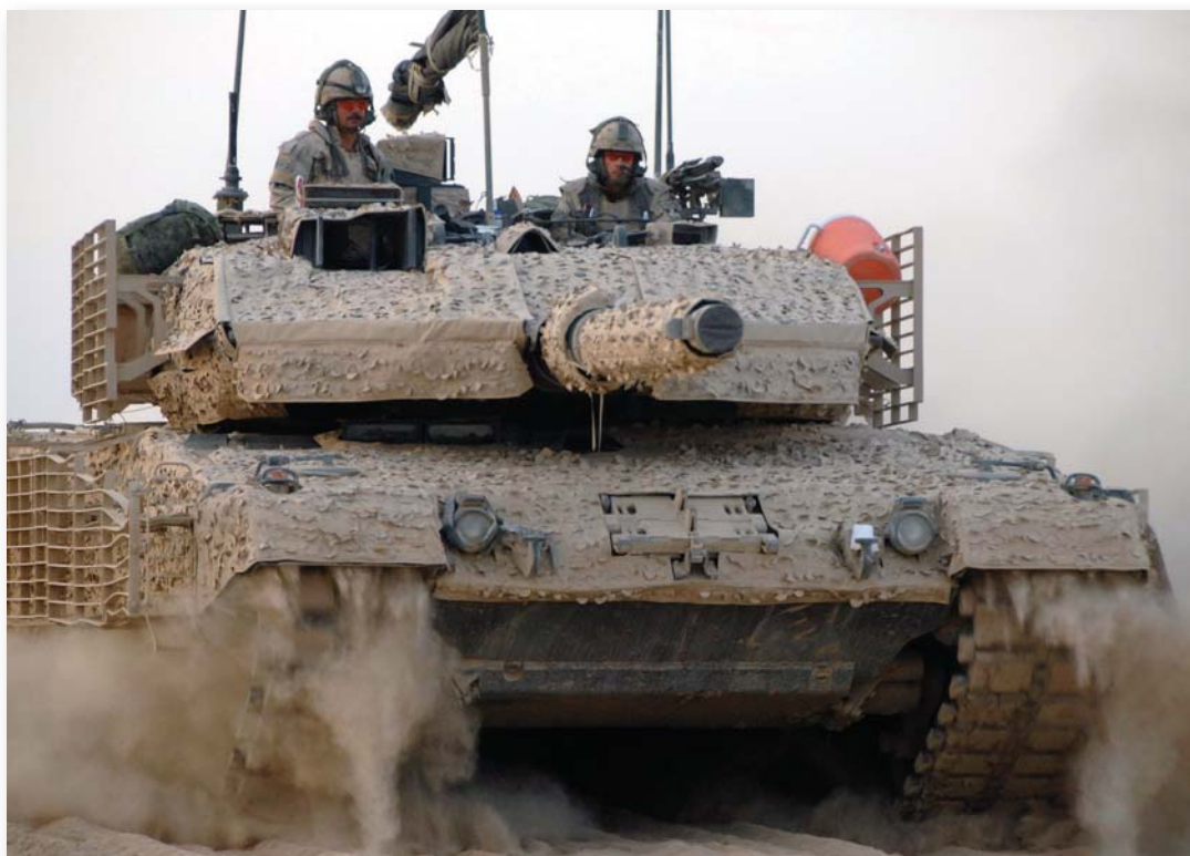
Leopard 2A6 припремљен за пустињска дејствија, опремљен догађајним оклопом типа „кавез“
