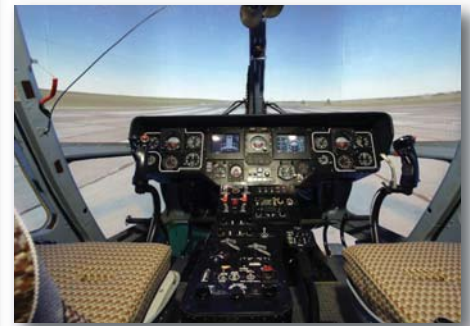
Инструментална табла „ансата” класичног је изгледа, у којем одударају дигитални показивачи моторских параметара
