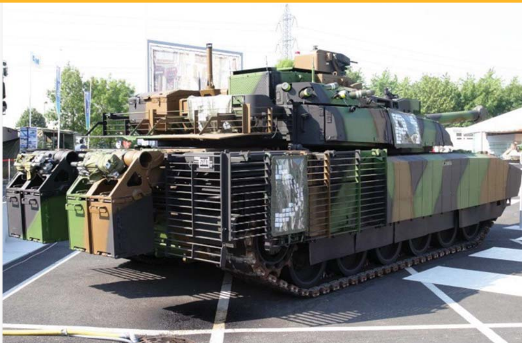
Leclerc AZUR, намењен за урбане услове борбе, са масивним догађним оклопом
