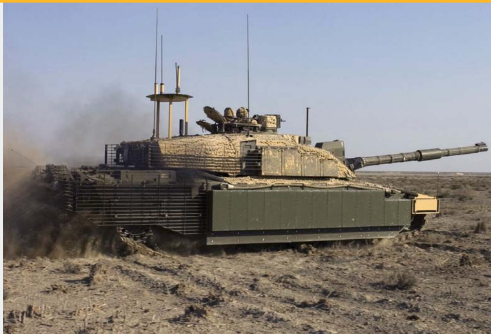
Бриџански Challenger 2, са оклојом кабез и масивним бочним оклојним модулима
